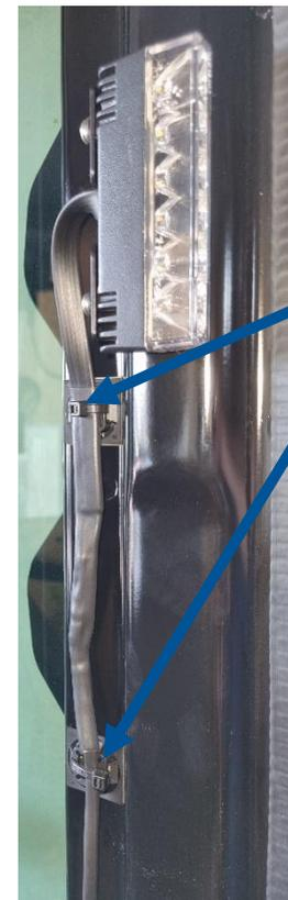
4) Fixieren Sie das Kabel mit den mitgelieferten Klebepads und den Kabelbindern entlang des Holms.
