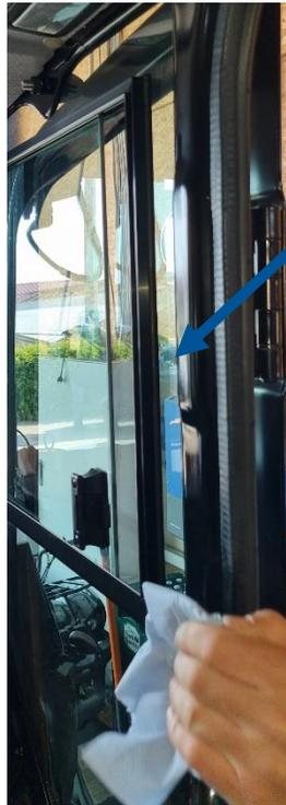
1) Reinigen Sie zuerst die Fläche des linken Seitenholms (Einstiegsseite). An dieser Stelle wird der Kabinenblitzer montiert.
